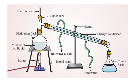
Fig. 2.14 : The Distillation apparatus
